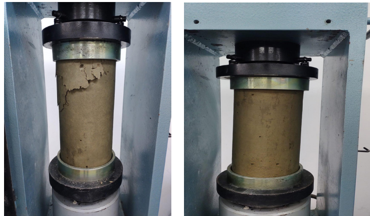
Fig. 4. Máquina de velocidad de carga con cilindro ajustado para pruebas de resistencia. Antes del fallo (izq.) y luego del fallo (der.).
