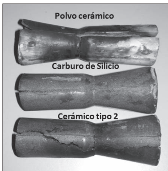
Figura 10. Grietas en dirección axial y en la garganta de los prototipos después del ensayo de llama.
