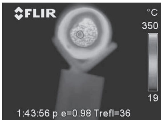
Figura 9. Foto termográfica de la zona posterior de prototipo de cerámico tipo 2
