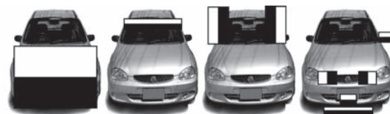
Figura 4. Estructura en cascada: cada imagen es un clasificador fuerte, aumento en complejidad de izquierda a derecha
