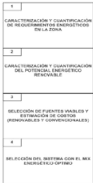
En primer lugar se deberá calcular la energía que el usuario necesitará diariamente. Para ello se deberá determinar la potencia de todos los aparatos de que constará la instalación, individualmente, junto con el tiempo medio de uso de cada uno de ellos. En caso de duda, tanto la potencia como el tiempo medio de uso se deberán redondear hacia arriba para dar un margen de diseño. Posteriormente se procederá a calcular los consumos por unidad de tiempo.
