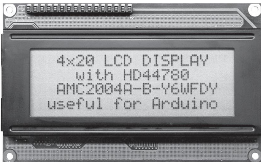
Figura 8. Pantalla LCD de 4 x 20 caracteres.
