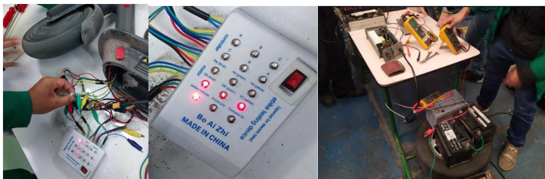
Figura 3. testing device ebikes y Fluke BT521 detectando las fallas.
